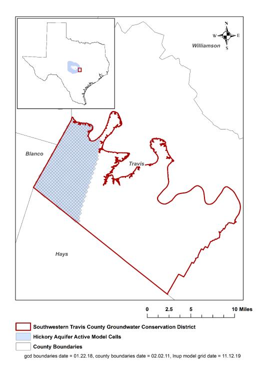
FIGURE 1 AREA OF THE GROUNDWATER AVAILABILITY MODEL FOR THE MINOR AQUIFERS IN THE LLANO UPLIFT REGION FROM WHICH THE INFORMATION IN TABLE 1 WAS EXTRACTED (THE HICKORY AQUIFER EXTENT WITHIN THE DISTRICT BOUNDARY).
